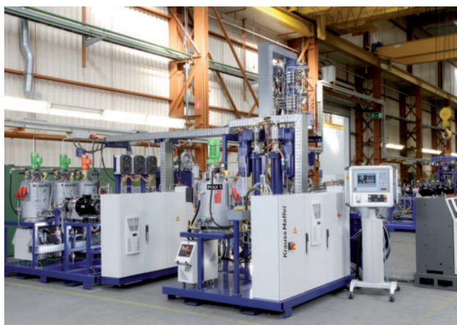
Fasersprühanlage zur Herstellung großflächiger Strukturbauteile mit einer anspruchsvollen optischen Oberfläche
